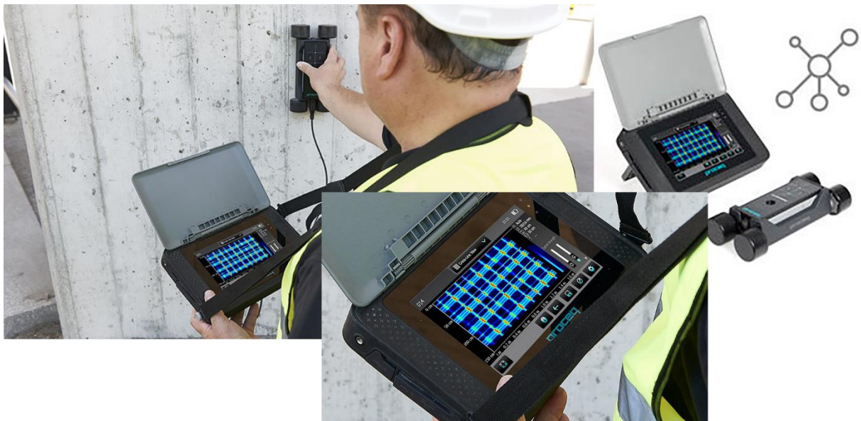
Figur 28. Täcksjikt och armeringsdetektering av digital täcksjiktsmätare Profometer 650 AI, PROCEQ (2017).
