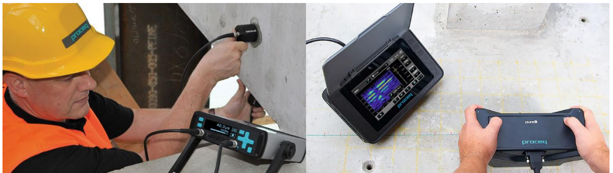
Figur 5. Tillämpning av UPV, Pundit 250 Array instrument, PROCEQ (2017).
