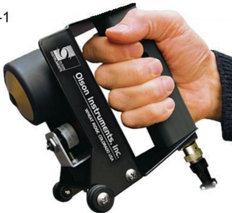
Figur 8. Handhållna IE system för mätning av betong. T.v. IE-1 för mätning av enskilda punkter. T.h. IE-S, rullande utrustning för mätning av större ytor, Olson-Instruments (2016)
