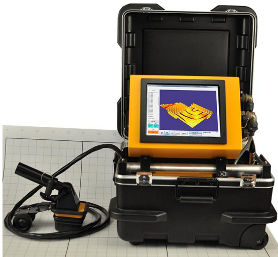
Figur 15. 2500 series mäter både 2D och 3D, USRadar (2016).
