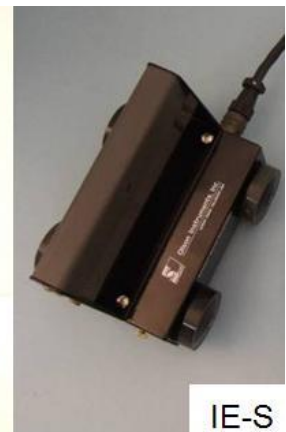
Figur 8. Handhållna IE system för mätning av betong. T.v. IE-1 för mätning av enskilda punkter. T.h. IE-S, rullande utrustning för mätning av större ytor, Olson-Instruments (2016)
